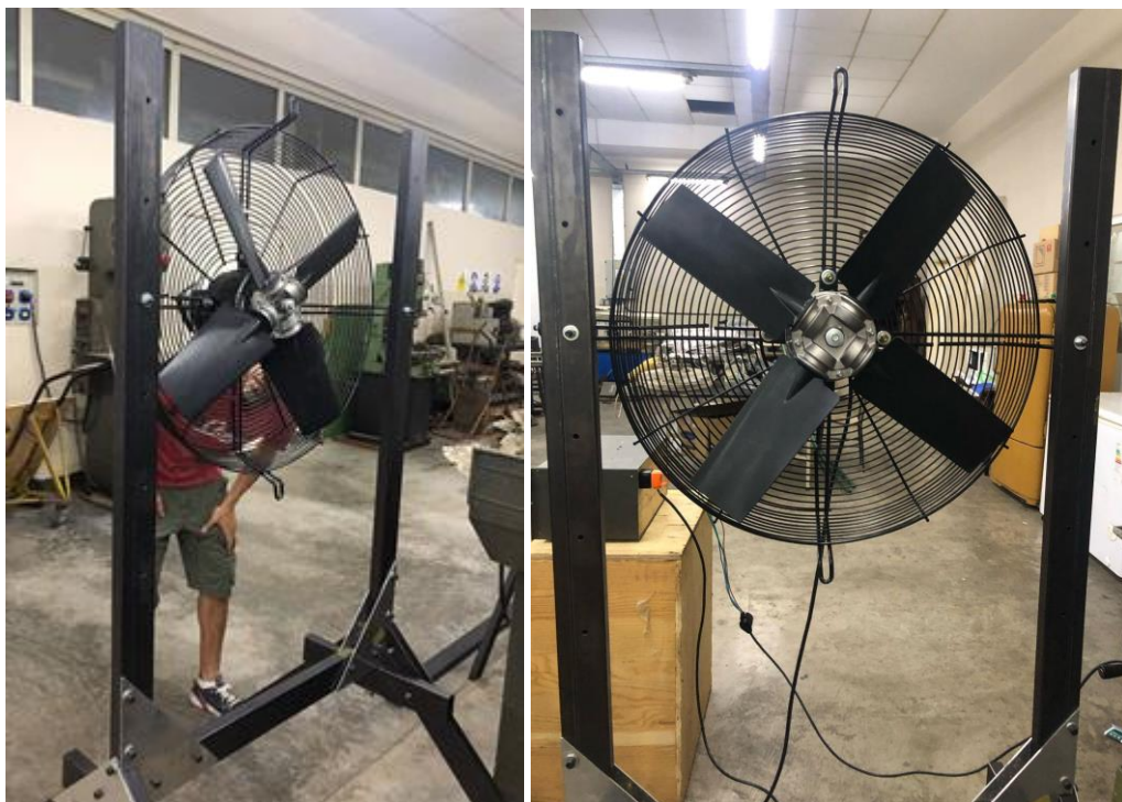
Figura 6 - Soporte del ventilador armado. Fuente: elaboración propia.
