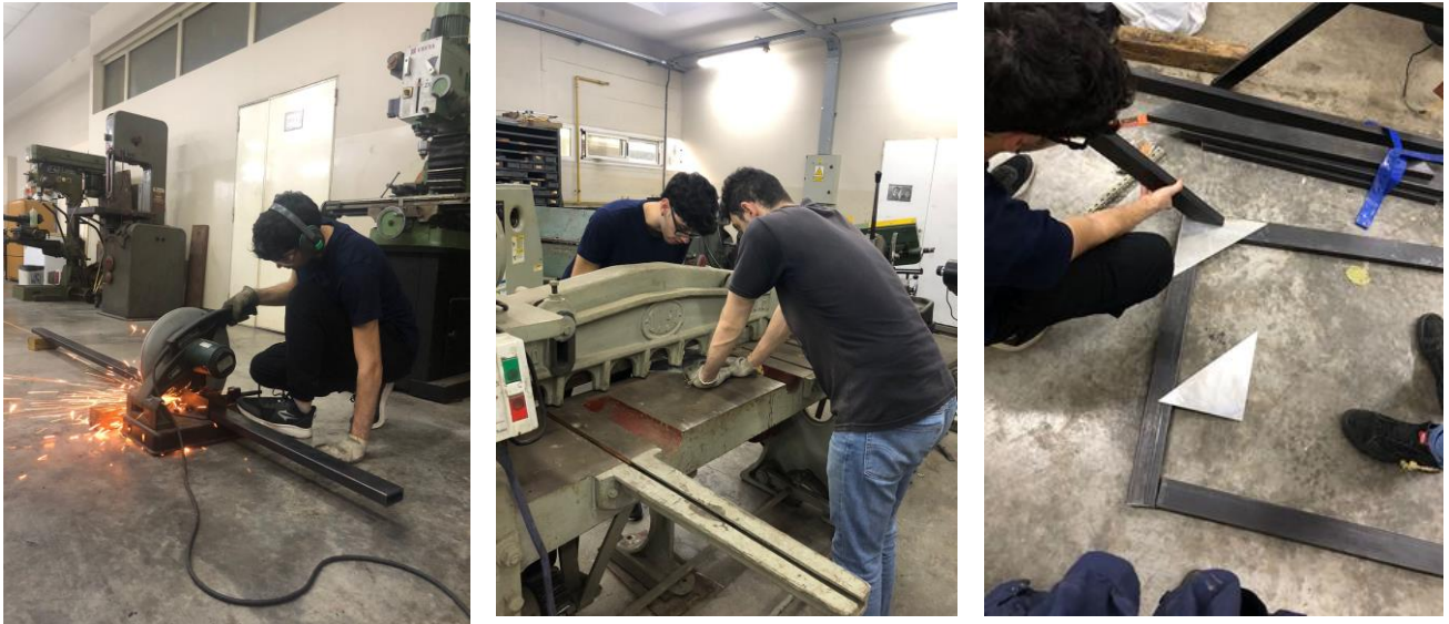
Figura 5 - Proceso construcción soporte ventilador. Fuente: elaboración propia.
